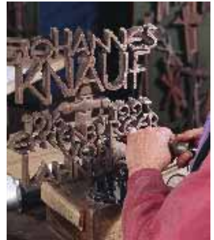
Ziselieren eines Schriftgitters
