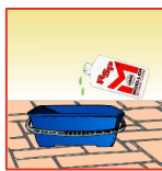
Produkt in Arbeitsbehälter füllen
