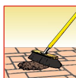
Grobe Schmutze trocken entfernen
