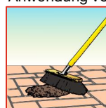
Grobe Schmutze trocken entfernen
