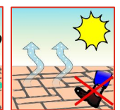
Ausreichend abtrocknen lassen
