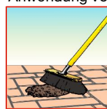
Grobe Schmutze trocken entfernen
