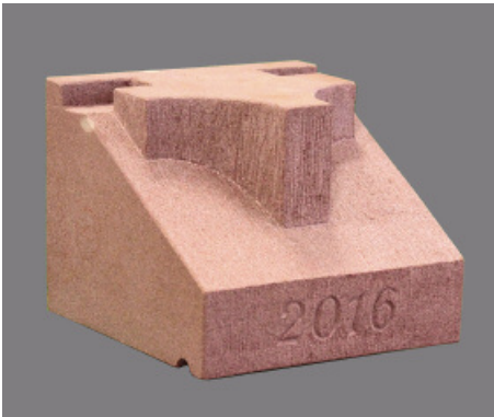
Gunter Dirichs Steinmetzarbeitsprobe, sieben Stunden Arbeitszeit, EIFELSANDSTEIN, rot
