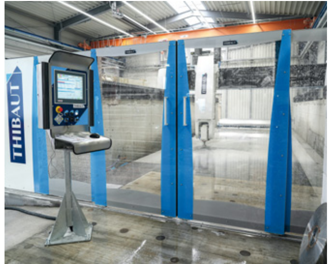
Das fünfachsiges CNC-Bearbeitungszentrum T858 V2 von Thibaut komplettierte als »letztes Puzzlestück« die Fertigung.
