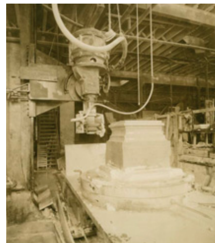
Durch den Drehtisch war es möglich, radial verlaufende sowie äußere Profilverkehrungen zu fertigen.
