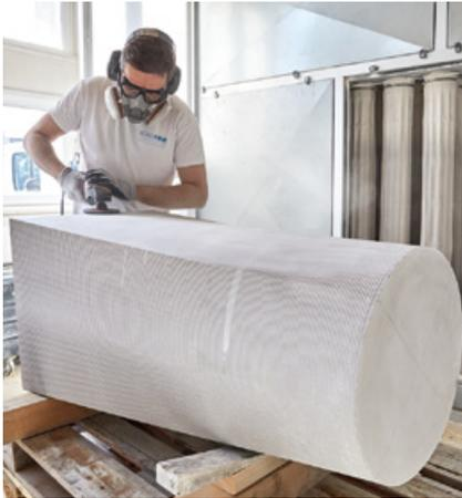
Feinarbeit nach der Drehbank: Steinmetze arbeiten Sägespuren am Ambo ab.
