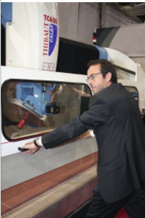
Bild 5: CNC-Säge TC650 von Thibaut (im Bild GF Jacques Thibaut): hohe Sicherheit durch Schwenktür Fotos: Dr.-Ing. Dieter Gerlach
