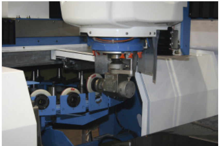
Bild 4: Ermöglicht Komplettbearbeitung durch intelligenten Werkzeugwechsel: Bearbeitungszentrum T812 von Thibaut
