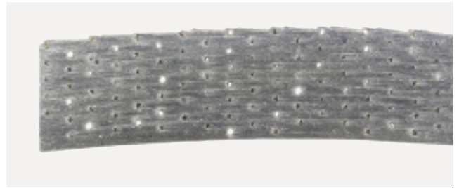
Bild 3: Seitenansicht eines Diamantsegmentes einer Trennscheibe von Dr. Fritsch Sondermaschinen; die weißen Punkte sind Lichtreflexionen von Diamantflächen Foto: Dr. Fritsch Sondermaschinen
