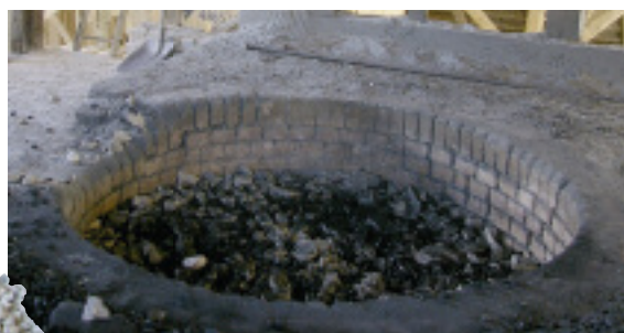
Nach der mechanischen Vorkonfektionierung im Brecher (l.) wird das Gestein lagenweise in einen nach oben offenen, 3 m hohen Ofen eingebracht (o.)
