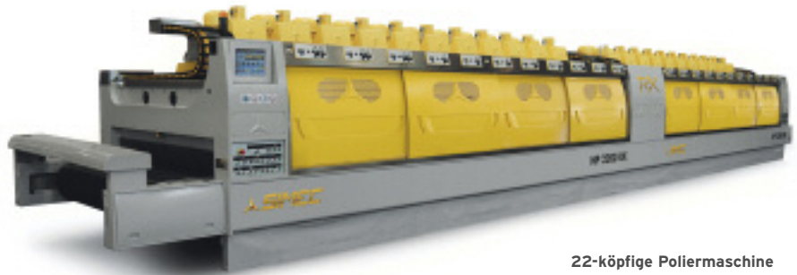
22-köpfige Poliermaschine für Granit von Simec
