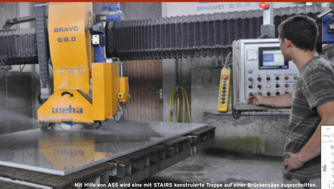
Mit Hilfe von ASS wird eine mit STAIRS konstruierte Treppe auf einer Brückensäge zugeschnitten.
