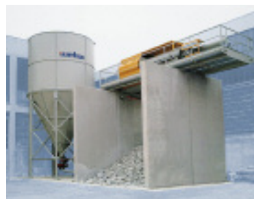
Teilansicht der Brauchwasseraufbereitungsanlage Mod. LINDO 600, installiert im Natursteinwerk Vorsfelde, Werk Oebisfelde
