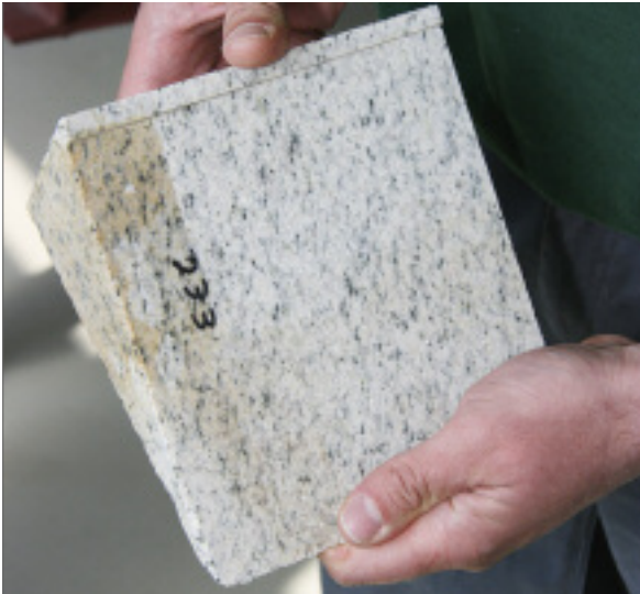
Was weiß blieb, ist mit DNS-I-233 imprägniert. Die untere Hälfte des Steins hat mehrere Monate in Humus gesteckt.
