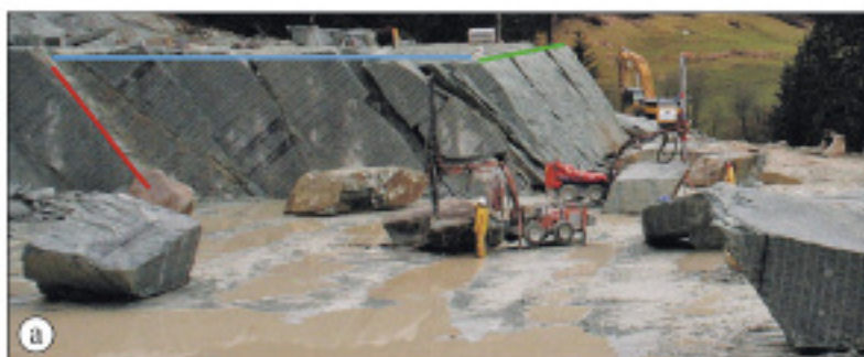
Abb. 1: a) Abbau der Varietät Verde Andeer (Orthogneis, Schweiz) im Steinbruch Bärenburg (Fa. Toscano AG); b) Schematische Darstellung des Trennflächengefüges des Bruchbereichs in a); c) Der generell spitze Winkel zwischen den Klüftscharen A und C hat schräge in-situ Blöcke zur Folge
