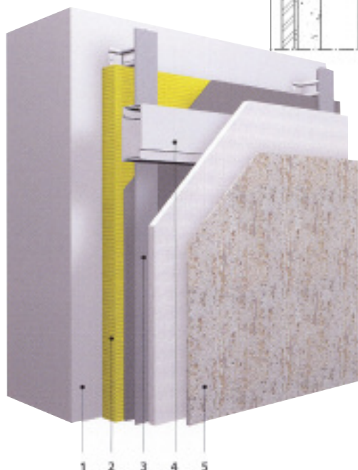
Fassadensystem »StoVerotec Stone Light« 1 Verankerungsgrund 2 Dämmung 3 Unterkonstruktion 4 Agraffenprofile 5 «Stone Light»-Panel (Trägerplatte aus Blähglas)
