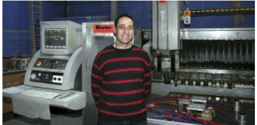
Mit dem CNC-Bearbeitungszentrum Practica führt Becker nicht nur seine eigenen Aufträge im Exklusivbereich aus, sondern fertigt auch für andere Steinmetzbetriebe.
