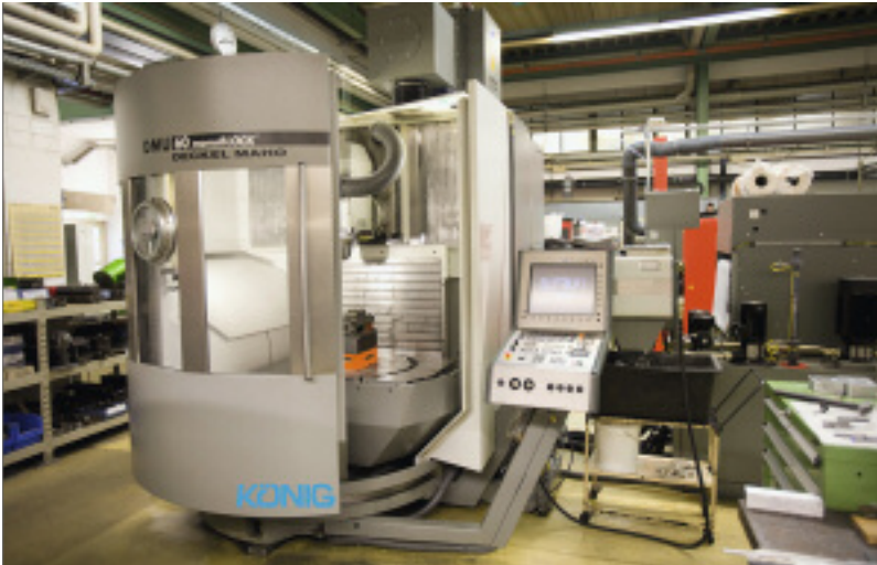
Ein Blick in die Karlsruher Produktion: die 5-Achs-CNC-Maschine zur Produktion der Klebevorrichtung
