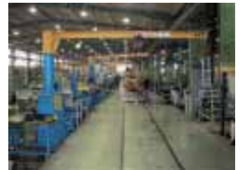
Der »Mobilus Schwenkkran« von Vetter ist ein idealer Beistellkran für wechselnde Arbeitsplätze.
