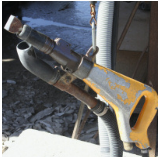
Bild 2: Am Federhubzug befestigter Keillochhammer mit Entstaubung
