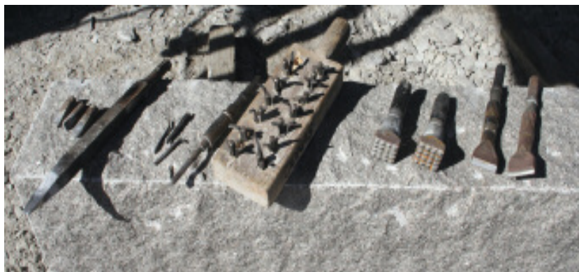
Bild 4: Eine Auswahl an Werkzeugen, die durch eine zweckmäßige Anordnung von griffbereiten Druckluftmaschinen staubfrei eingesetzt werden können.
