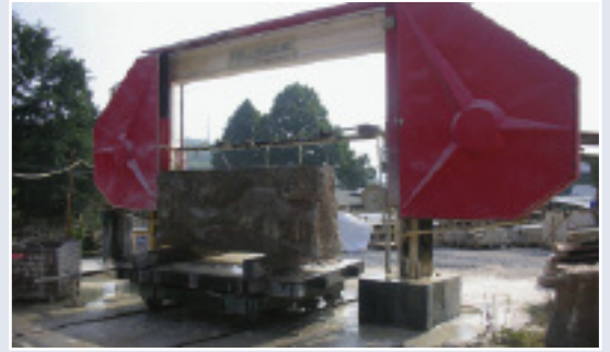
Eine Seilsäge von Pellegrini gehört zum Maschinenpark.
