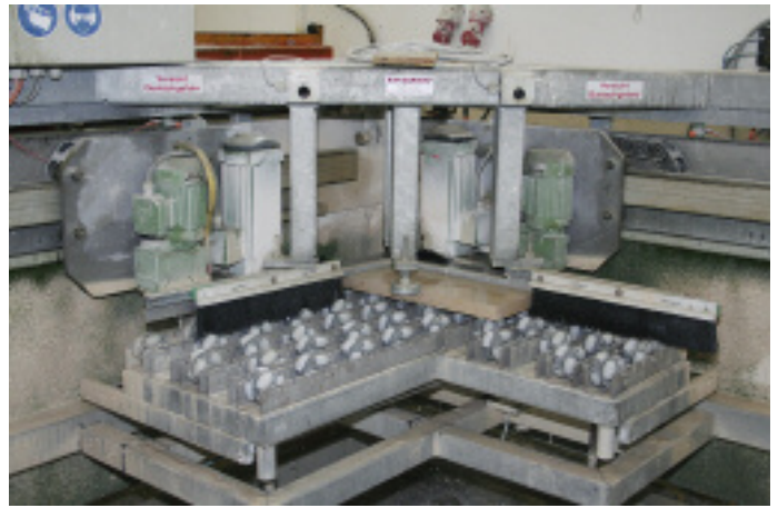
Bild 6: Spezialmaschine zum Einbringen der horizontalen Nute für die tk-Fertigfuge
