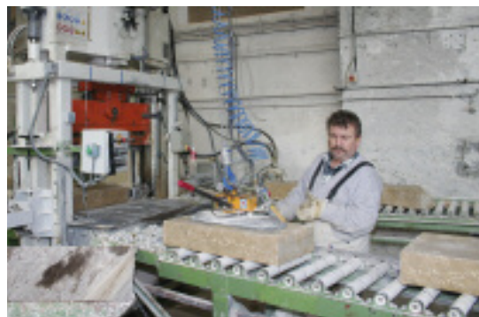
Bild 4: Fertigung gesägter und gespaltener Blockstufen
