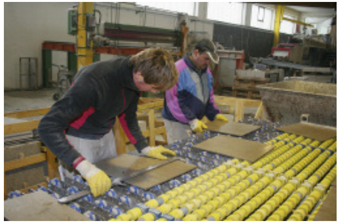
Bild 2: Endkontrolle der Fliesen- und Bodenplatten
