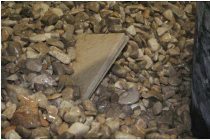
Bild 5: Antikisierung von Bodenplatten in einem Rundvibrator
