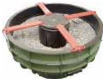
Die Bearbeitung in einem Rundvibrator erfolgt Teil gegen Teil oder mit Hilfe von Schleifkörpern.
