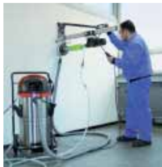
Der Starmix-Recyclingsauger kühlt auch Diamantwerkzeuge.
