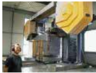
Uwe Schultz an der Blockbearbeitungsmultisäge von Pellegrini
