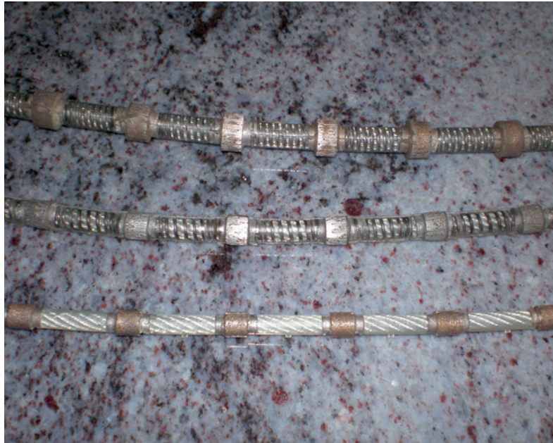
Die Tendenz ist eindeutig – es geht zum immer dünneren Seil. Von oben nach unten: 11 mm-, 8 mm- und 6 mm-Seil mit Kunststoffverspritzung
