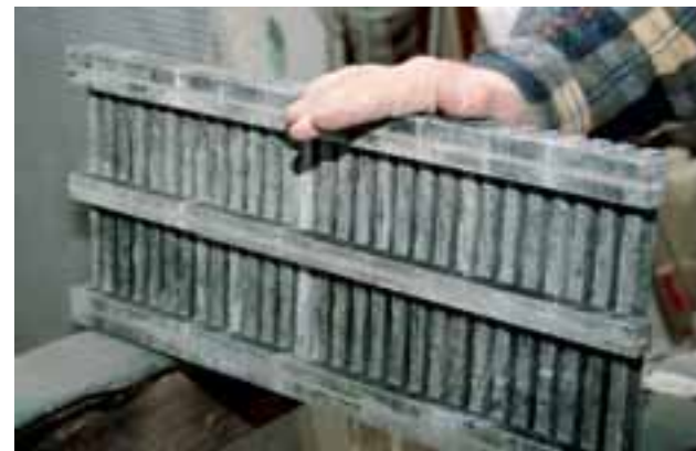
Steinmetzarbeit und Ablaufrinne Granit
