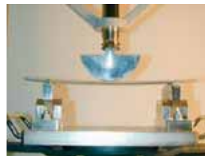
Bestimmung der Verformbarkeit zementärer Dünn-/Mittelbettmörtel gemäß DIN EN 12002
