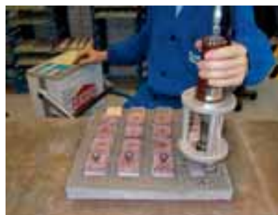
Bestimmung der Haftzugfestigkeit gemäß DIN EN 12002
