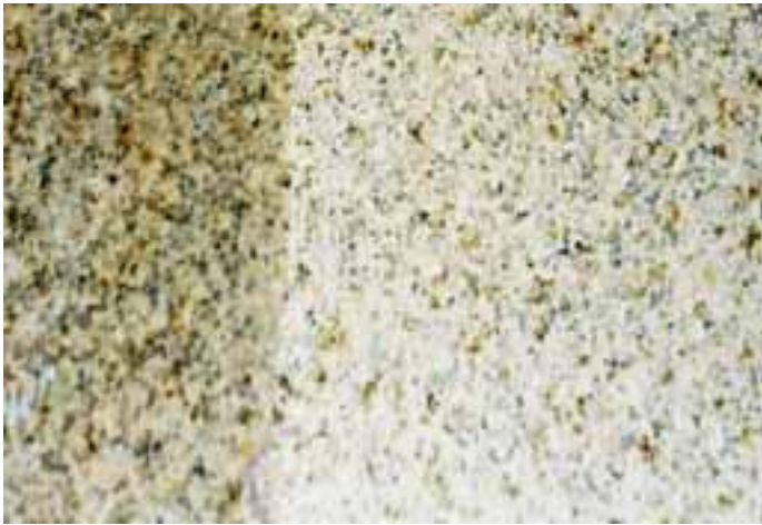
Reaktion eines Granits auf die Applikation von Haftsclämmen: Bildmitte: nicht benetzt (Referenzfläche); links: Verfärbung durch eine nicht geeignete Haftsclämme. Rechts: keine Veränderung nach rückseitigem Auftrag der Mapei-Haftsclämme Mapestone 3
