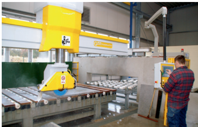
Fertigung mit der 5-achsigen Sägeanlage, die die Adamczyks gemeinsam mit der Firma König entwickelt haben.
