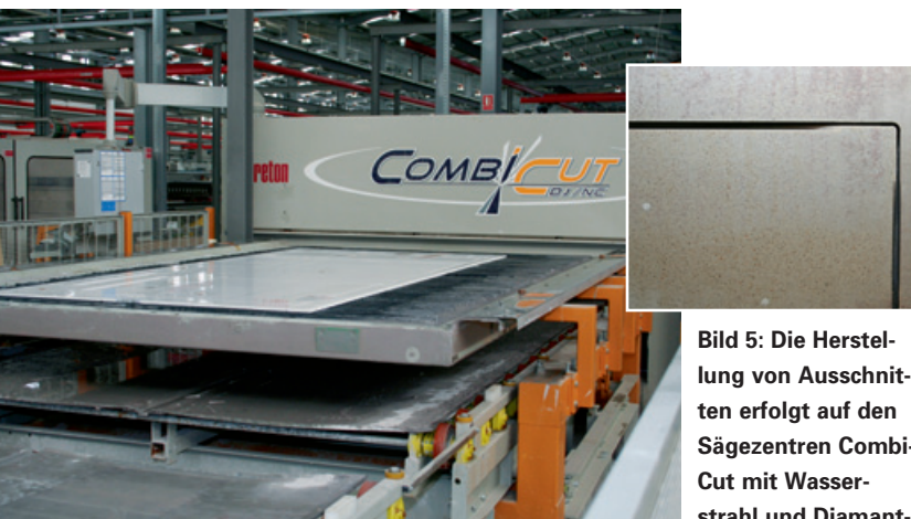
Bild 4: Sägezentrum CombiCut DJ/NC mit Wechseltisch (obere und untere Ebene)
