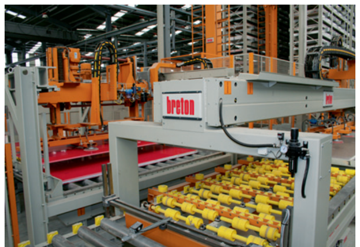
Bild 2: Sortier- und Stapelanlage für Rohplatten
