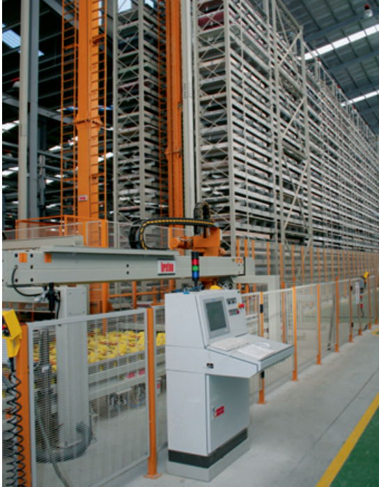
Bild 3: Hochregallager für bis zu 1500 Rohplatten
