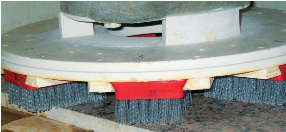
Bürsten Typ Frankfurt an einem Schleifteller für die Oberflächenbearbeitung von Naturstein
