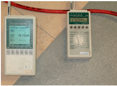
Digitale Anzeige Last und Verformung
