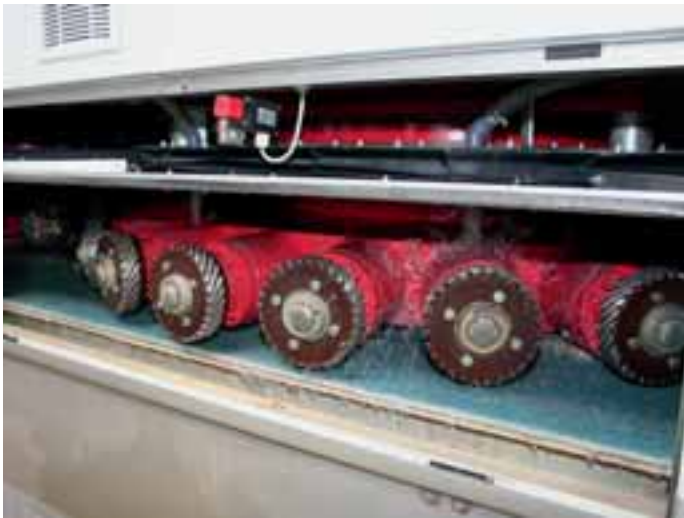
Bild 4: Eine von zwei Schleifstationen der Kalibriermaschine
