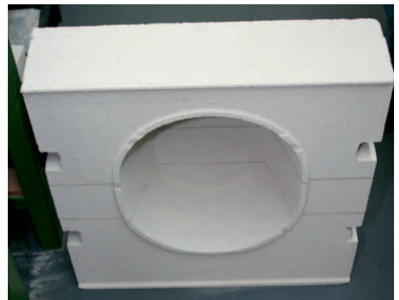
Bild 3: Modell eines Massivwaschbeckens; reine Bearbeitungszeit in Marmor: 15 Minuten
