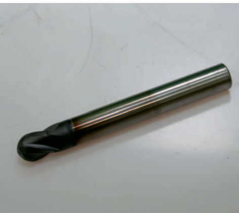
Bild 1: Fräswerkzeug mit Halbkugelkopf der Firma JABRO Tools BV, bestehend aus einem zylindrischen Stahlschaft und beschichtetem Vollhartmetallfräskopf
