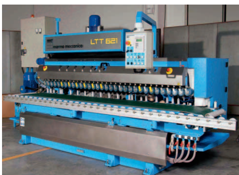
Kantenautomat LTT 621 für horizontal liegende Werkstücke
