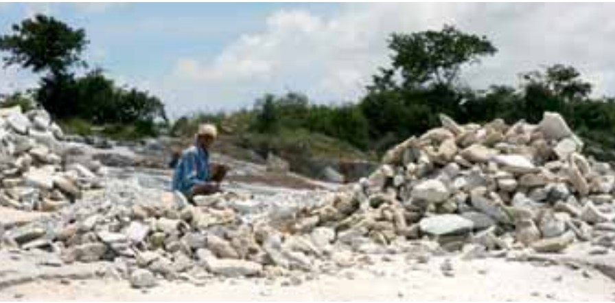
Im Umfeld vieler Brüche – auch Exportsteinbrüche – werden Abfallsteine zu Schotter und Splitt für regionale Bauvorhaben zerkleinert.
