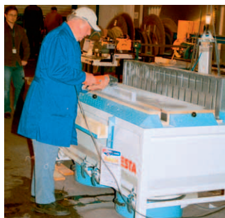
Vom weha-Partner ESTA entwickelter Absaugtisch mit Trockenentstaubung
