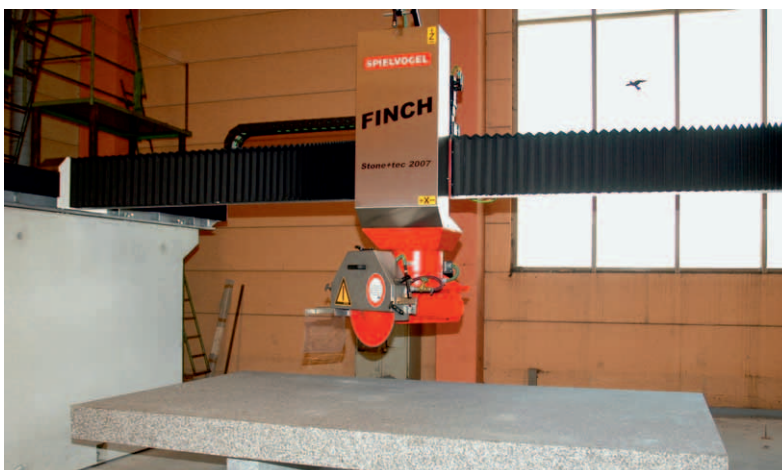
Gesamtansicht der Brückensäge Finch Komplex mit Bänketisch aus Stein
