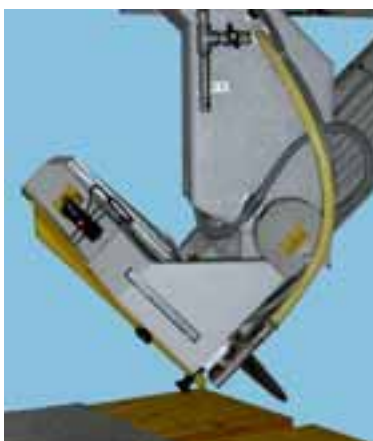
Dreh- und schwenkbarer Sägesupport der Brückensäge Litox
