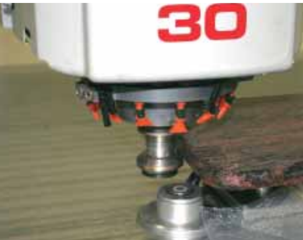
Bild 3: Kollisionsprüfung mit einem neu montierten Fasenwerkzeug an einem eingefahrenen Positionieranschlag
