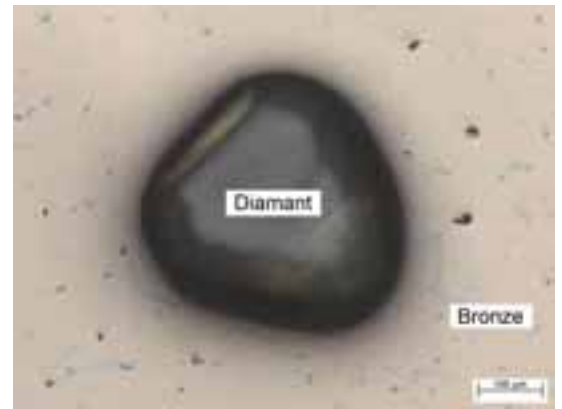
Bild 3: Diamantsegment gleicher Zusammensetzung wie bei Bild 2 nach der Kapselung und anschließendem HIP-Prozess mit einer mittleren Porosität von 0,8 %.
