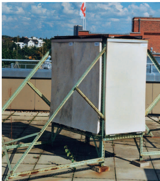
Ausgelagerte Platten in einem Versuchsstand auf dem Dach eines Bürogebäudes der BAM
