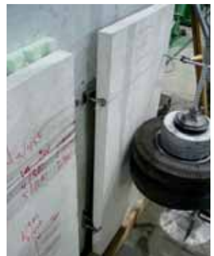
Test bei der LGA – Aufprall eines pendelnd gelagerten Zwillingsschleifens auf die Natursteinplatte aus einer Fallhöhe von 600 mm
