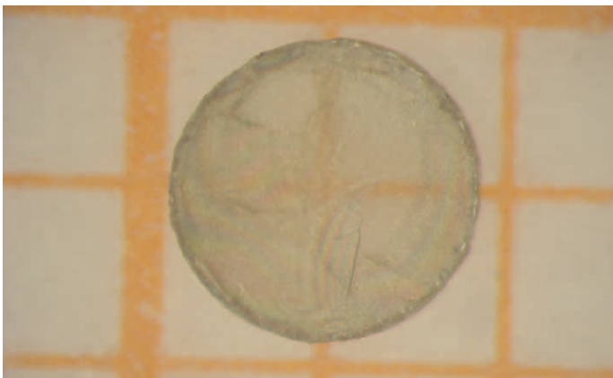
Bild 1: Das neue Material ADNRs (aggregated diamond nanorods), abgebildet auf Millimeterpapier, ist härter als Diamant
