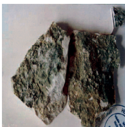
Vor Ort abgeplatzte bzw. ausgebaute Bruchstücke mit grünlicher, tonhaltiger Oberfläche
