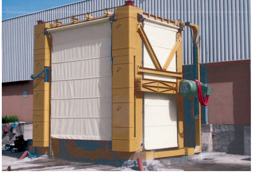
Die neue Arianna-Maschine von Wires Engineering mit 72 Diamantdrähten
