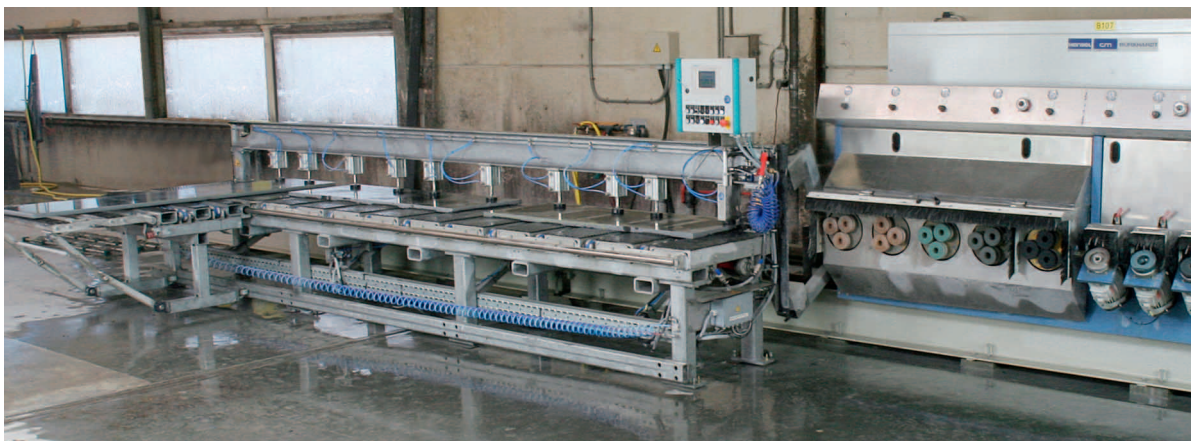
Gesamtansicht der Anlage zum Schleifen und Polieren gerader Kanten und Fasen bestehend aus Kantenschleifautomat KSA 579, Arbeitstisch Modell A 564 und Tischverbreiterung (am linken Bildrand)
