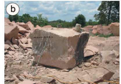
Abb. 2: Formatierung von Rohblöcken in thailändischen Granit-Lagerstätten
