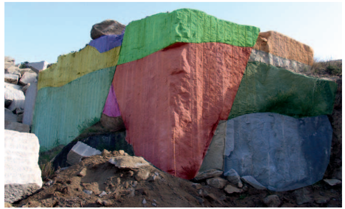
Abb. 6: Zergliederung eines Lagerstättenbereichs in mehrere in-situ Blöcke verschiedener Größen. Zur Veranschaulichung der mit 3D-Block-Expert möglichen Modellierungen (vgl. Abb. 7) sind einzelne Blockpartien farblich dargestellt.
