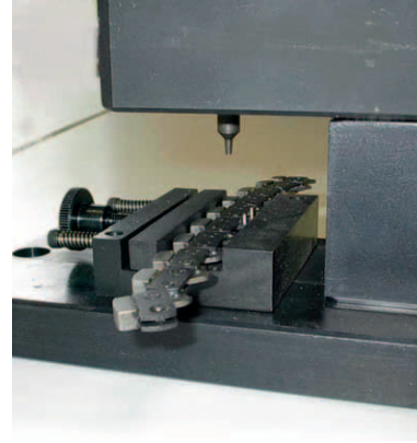
Montagevorrichtung zur Herstellung von geschlossenen Sägeketten aus Meterware
